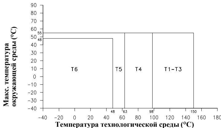
Максимальная температура поверхности при запыленности: T6:T 80°C, T5:T 95°C, T4:T 130°C, T3- T1:T 182°C.
