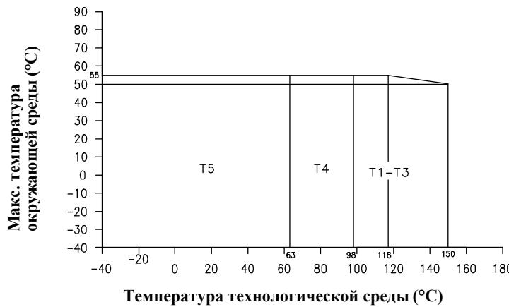
Максимальная температура поверхности при запыленности: T5:T 95°C, T4:T 130°C, T3 - T1:T 182°C.
