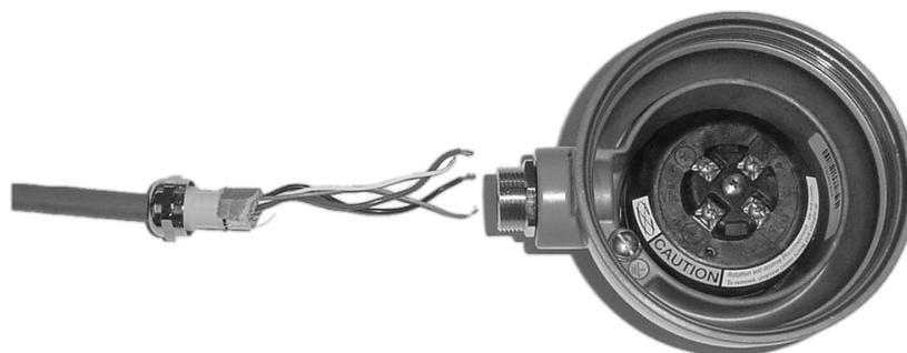
5. Провести проводку через корпус уплотнения и собрать уплотнение с помощью затягивания уплотнительной гайки.
