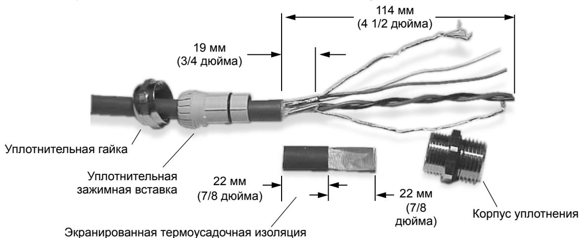
4. Для подключения на корпусе базового процессора, подготовить экранированный кабель следующим образом (для бронированного кабеля опустить этапы г, д, е, и ж):
