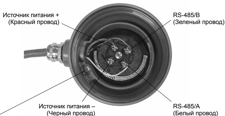
**Внутренний винт заземления корпуса базового процессора**
