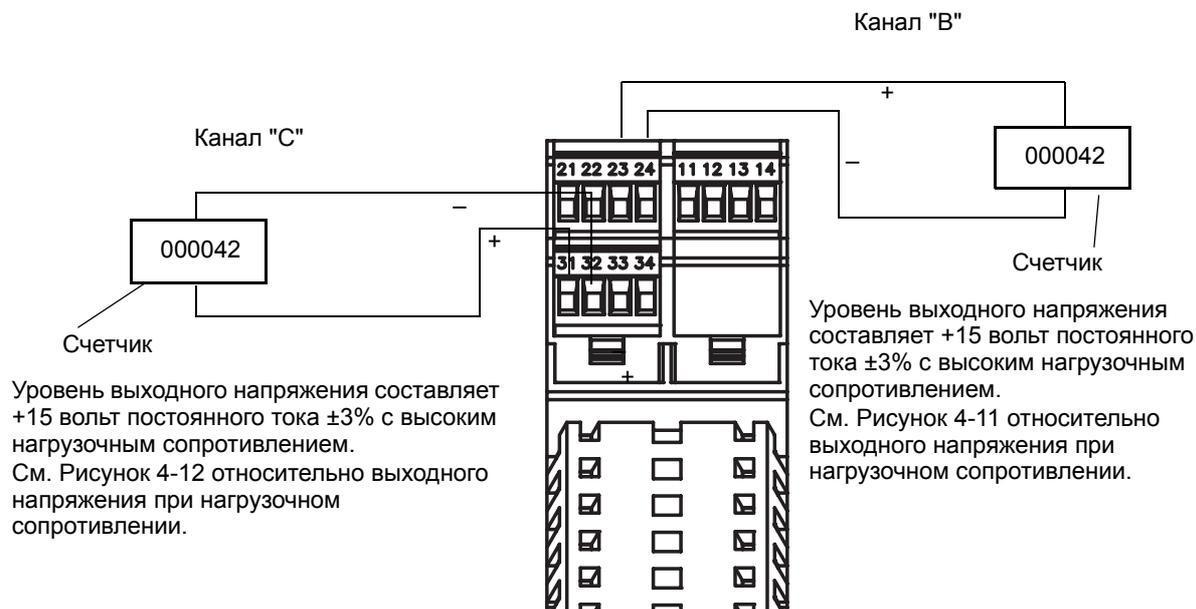
Рисунок 4-5 Проводка частотного выхода – внешний источник питания
