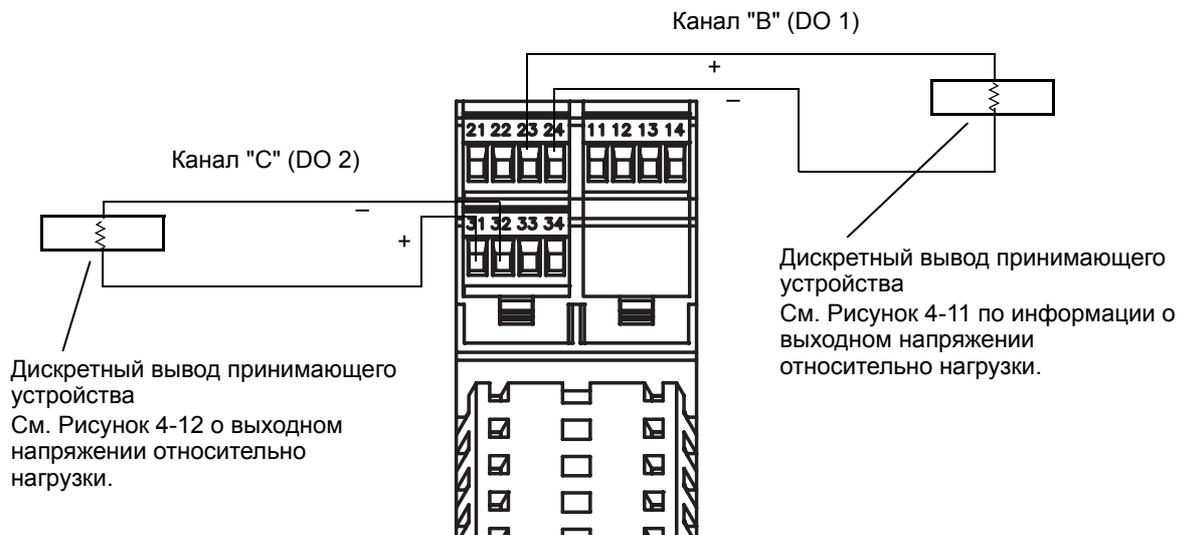
Рисунок 4-7 Дискретная выводная проводка – внешний источник питания
