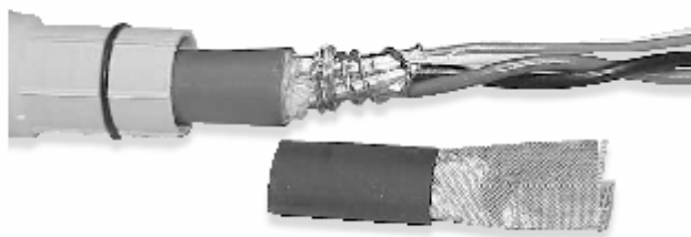
Рисунок 1-8. Обвязка экранированных проводов утечки
