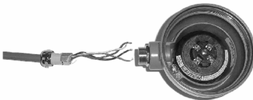
Рисунок 1-11. Корпус сальника и оболочка базового процессора
