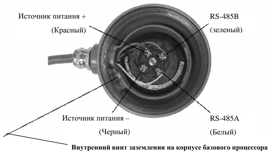
Рисунок 1-12. Подключение проводов к базовому процессору
