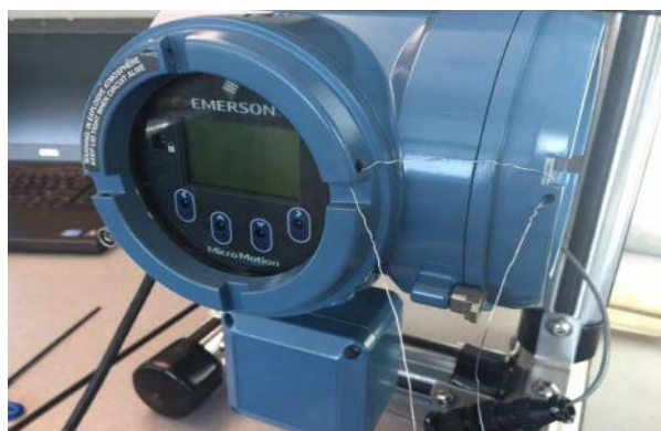
Рисунок 8 - Вариант пломбирования корпуса электронного преобразователя модели 5700
