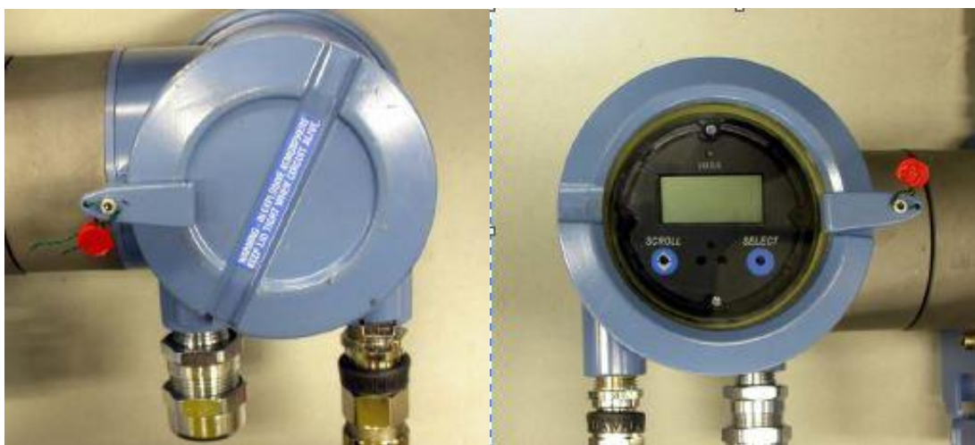
Рисунок 7 - Вариант пломбирования корпуса электронных преобразователей моделей 1700, 2700
