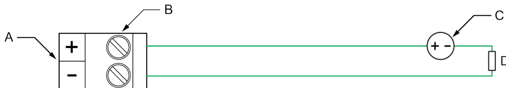
Рисунок 4-7. Подключение дискретного выхода к реле или индикатору
