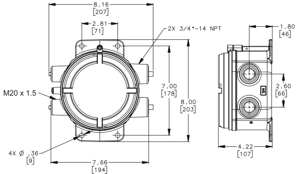
Корпус электронного блока удаленного базового процессора 800C
